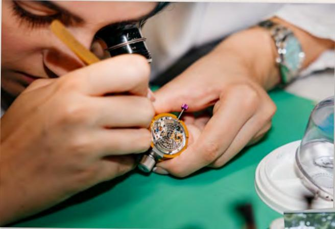
Ich arbeite an dem, was man ein Uhrwerk nennt: das Herz der Uhr. Ich benutze eine Pinzette, weil die Teile, die ich zusammenfüge, mikroskopisch klein sind. Um die Details der Teile perfekt zu sehen, trage ich ein Mikroskop, das wie eine Lupe funktioniert.
