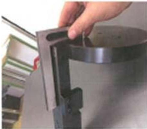
17. Die Rückplatte besteht aus zwei Stahlplatten. Auch die werden nach Plan auf die Länge gefräst, gebohrt und angesenkt, dann wird alles mit der Grundplatte zusammengeschaubt
