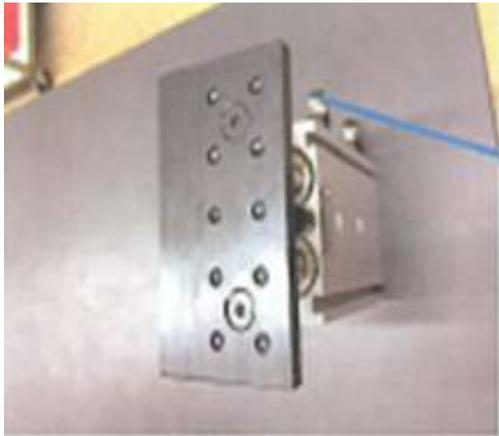
19. Da wir nur Kunststoffteile zum Pressen haben und die Presskraft nicht zu hoch sein muss, habe ich einen pneumatischen Zylinder genommen. Die Presskraft lässt sich stufenlos durch die Reduzierung des Eingangsdrucks regulieren. Beim Zylinder habe ich eine Stahlplatte genommen, die habe ich mit den Zylindern zusammengeschaubt. Die Platte soll nachher die Kunststoffteile einpressen.
