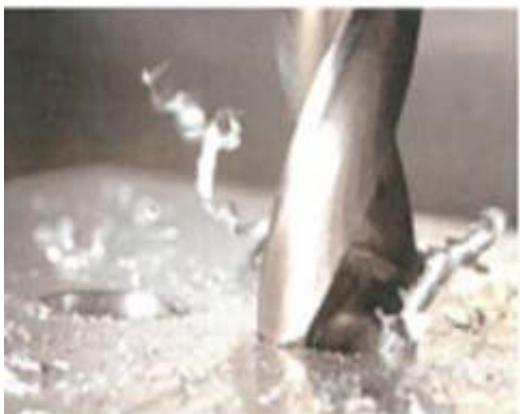
**Bohren:** Bohren, Gewindeschneiden, Senken, und Reiben sind spanende Fertigungsverfahren mit mehrschneidigen Werkzeugen.
