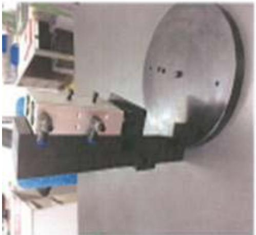
20. Den pneumatischen Zylinder habe ich an der Rückplatte angeschraubt und die Ventilsteuerung montiert. Die Kolbenstangen eines Pneumatik-Zylinders sollten über einen Taster gesteuert werden. Die Zylinder sollen ausfahren, wenn der Taster betätigt wird. Der Zylinder soll wieder einfahren, wenn der Taster nicht mehr betätigt wird.
