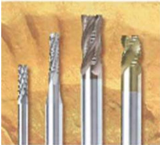
**Schlichtfräser:** Schlichtfräser bestehen üblicherweise aus Schnellarbeitsstahl oder Hartmetall. Nur in seltenen Ausnahmen kommen Keramik zum Einsatz. Die Schlichtfräser sind in zahlreichen Geometrien erhältlich: mit zylindrischem oder konischem Schneidteil, mit ebener oder gerundeter Stirnschneide, verschiedene Drall Winkel, Schneidenzahlen. Es gibt noch Walzenstirnfräser, Walzenfräser, Halbkreisformfräser, Messerkopf, T-Nutenfräser, Prisma Fräser, Winkelfräser, Fasen Fräser.
