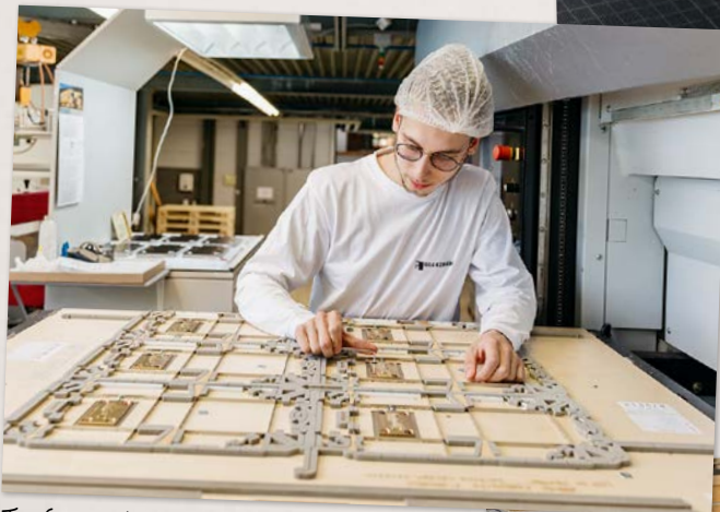
Je ferme les clichés de la forme de découpe. Ensuite, je continue à paramétrer la machine de découpe.
