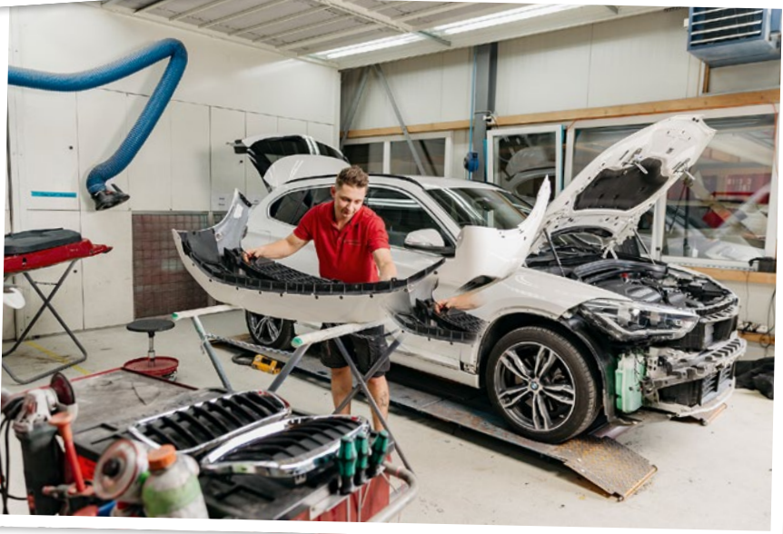
Les protections à l'intérieur du pare-chocs sont démontées.
